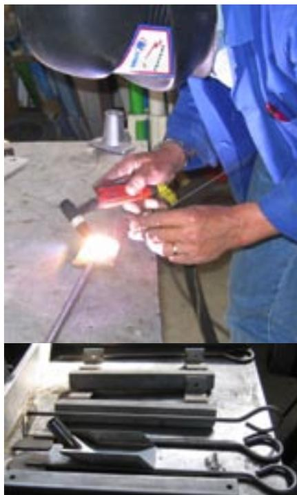
*Le bâti de la machine, les ringards et autres pelles à charbon sur des modèles d'époque mais de réalisation contemporaine.*
