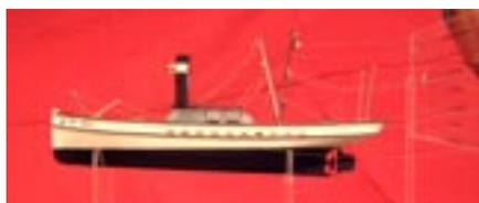
Maquette de la chaloupe à vapeur N°3 « Augustine » BA 1177 Longueur 14,50m largeur : 2,90m Tirant d'eau 1,20m Vitesse 8, 5 noeuds Chaudière Field – Machine Compound de 15 CV - Chantiers Letamendia Frères à Ciboure. Maquette réalisée par l'association Itsas Begia à Ciboure
