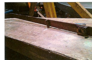
Emmanchement carré sur l'hiloire tribord
