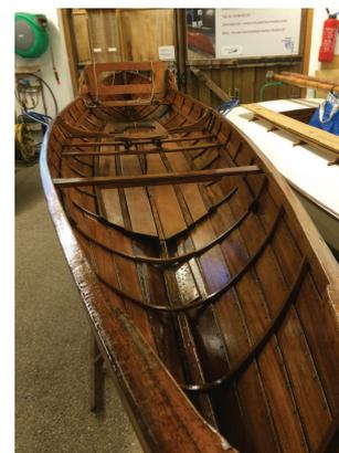
Travail délicat mais nécessaire sur Jako : nettoyage, grattage, découpe de la partie du bordé "vermoulu" ; découpe, rabotage et mise au gabarit d'une planche acajou ; préparation, collage, ponçage du scarf ; rivetage sur la partie du galbord refaite, "renforcement" quille intérieure, application de deux couches de vernis sur coque intérieure et extérieure, nettoyage et repositionnement de l'accastillage
