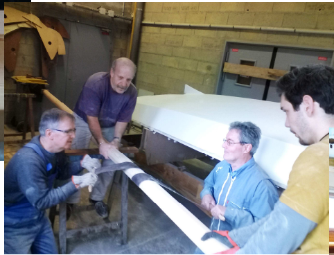
Ponçage du mât: opération qui va lui donner sa forme arrondie
