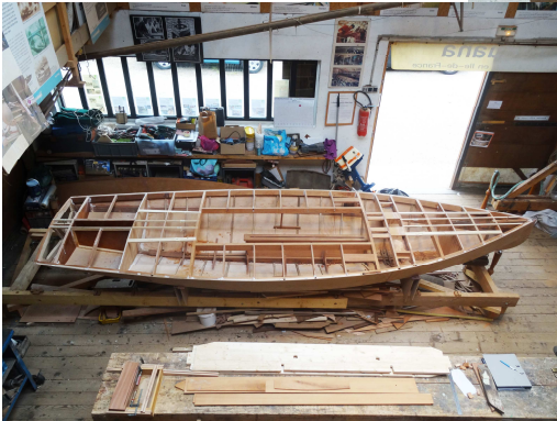
Début de construction du pont
