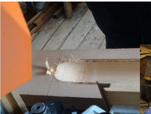
Evidement du mât à la toupie pour l'alléger et lui donner un peu de souplesse
