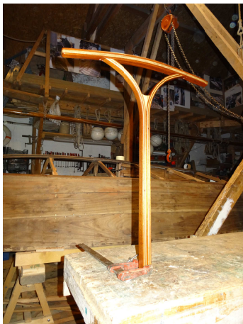
Evidement du mât à la toupie pour l'alléger et lui donner un peu de souplesse
