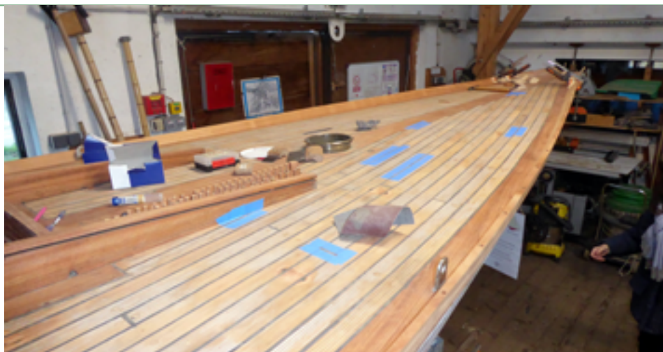
Le pont est composé de lattes de pin d'Orégon larges de 50 mm et les fougères et plats-bords sont en acajou
